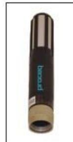
Conectada directamente en el instrumento, la sonda ambiente simplifica la captación de los parámetros ambientales. Tanto la temperatura como la humedad relativa son medidas con la misma precisión que mediante la sonda in situ.
