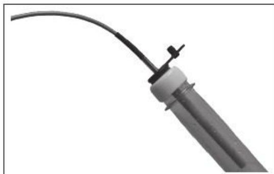
El tubo estándar de humedad permite una rápida y fácil verificación en el emplazamiento del funcionamiento y de la calibración del instrumento y de la sonda in situ del modo recomendado por ASTM.
